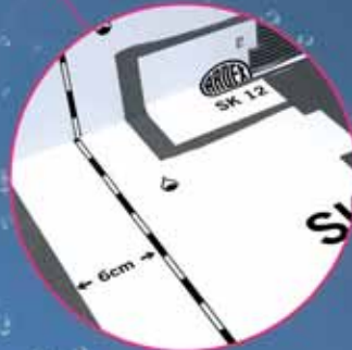
Duvar ve Zemin Birleşme Kenarları
